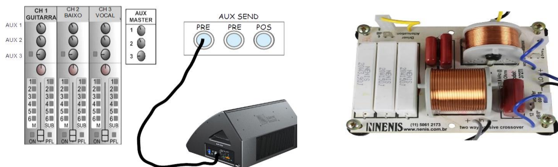
Figura 7: Esquema de ligação monitor placa passiva 4 ohms 2 vias
